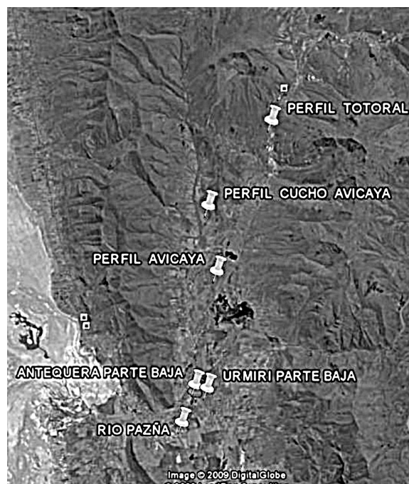
FIG. 1.— (1) El curso del río Antequera por la quebrada de Totoral, (2) la parte oriental de la parte media y ancha de la cuenca del río Antequera (zonas de remoción de sedimentos por la ex empresa minera ESTALSA), que incluye la laguna de decantación (manchas negras en la fotografía), y (3) la zona de manchas negras y grises de la parte media y baja de la misma, son las regiones de mayor contaminación superficial y de profundidad media.
