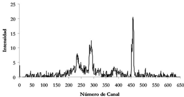
Figura 8. Espectro de luz de una lámpara de vapor de hidrógeno, en ella se observa la presencia de tres picos que corresponderían a las líneas  $H_{\alpha}$ ,  $H_{\beta}$  y  $H_{\gamma}$  de la serie de Balmer del hidrógeno.
